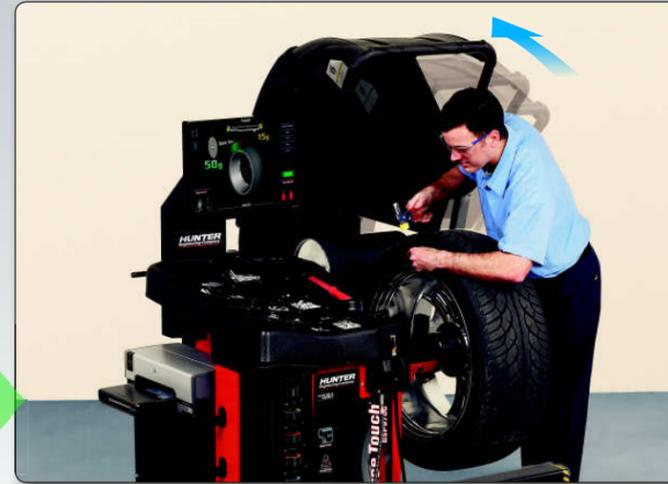
Кожух поднимается автоматически, оператор прикрепляет грузики и опускает кожух для проверки.
