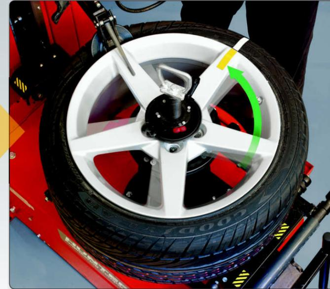
Необходимо совмещение жесткой части шины с "вмятой" частью диска для обеспечения идеально круглой при качении формы.
