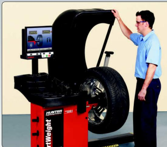
Балансировка начнет работать после опускания кожуха
