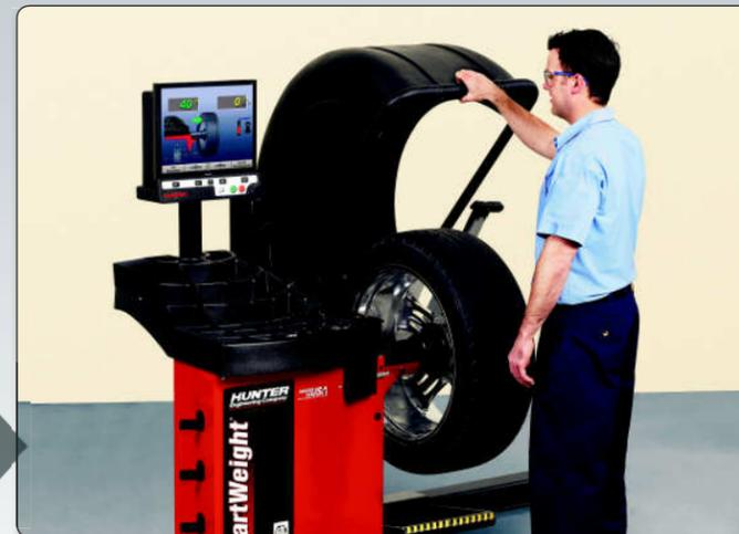
Оператор вручную поднимает кожух, прикрепляет груз, опускает кожух для проверки
