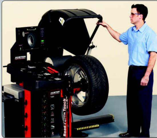
Виброконтроль начинает работать сразу же после опускания кожуха
