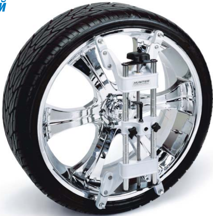
Самоцентрирующий колесный адаптер с опционными расширителями до 28". На фотографии установлены на диск диаметром 26".
