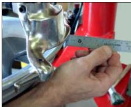
6. После того как Вы установили головку в нужном положении попеременно затяните болты, что бы зафиксировать её в таком положении.
