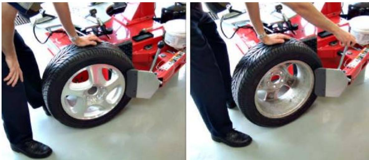
Наступите на педаль привода разбортировки. Рычаг отжимания борта будет прижимать колесо к станку, освобождая борт шины.
