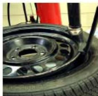
**ВАЖНО:** Для предотвращения поломки пластиковых насадки и головки во время демонтажа, монтажная головка должна полностью сидеть на внешнем крае диска до приложения усилия монтировкой при демонтаже.
