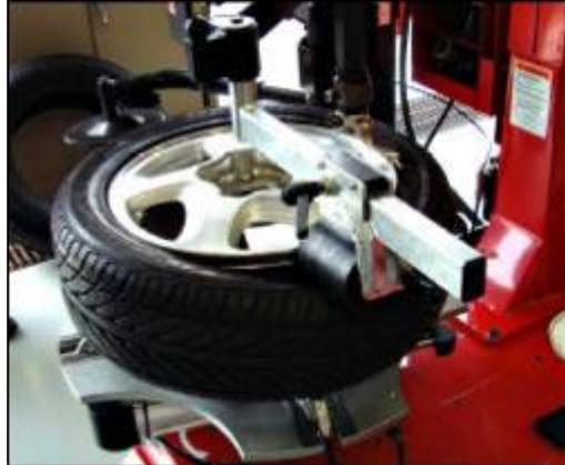
Более низкое подъемное приспособление борта может использоваться вместо ролика, чтобы повторно прижать более при демонтаже.
