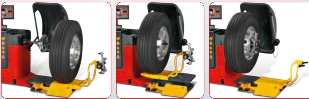
La WB690 è dotata di sollevatore pneumatico con comandi a pedale per la salita e la discesa di grande potenza e portata, che consente di centrare con facilità e sicurezza pneumatici di notevoli dimensioni e pesi fino ad un massimo di 200 Kg.
