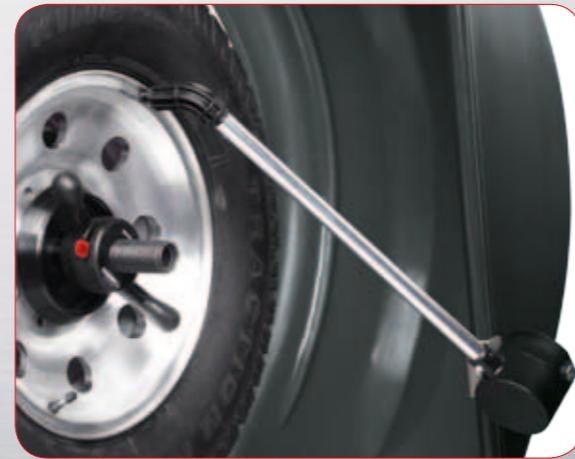
Tastatore esterno. Calibro automatico esterno per l'inserimento della larghezza ruota.
