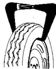
в – измерение ширины колеса кронциркулем
