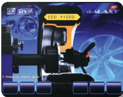
Прямое измерение осуществляется автоматически двумя электронными линейками. Для ввода размера достаточно подвести линейку к плоскости установки груза.
