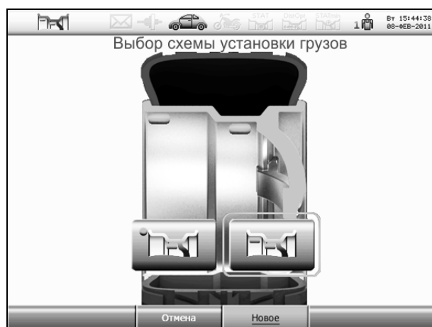
Рисунок 6.11 – Схемы установки грузов
