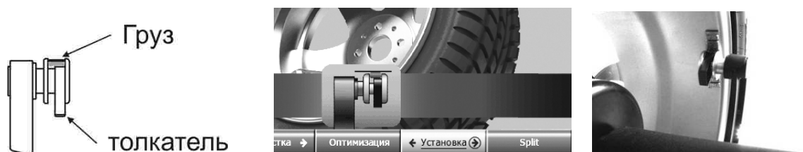
Рисунок 6.13 – Установка груза линейкой
