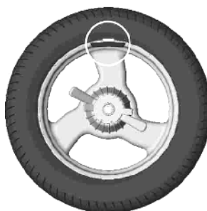
Рисунок 6.6 - Груз установлен в «12 часов»
