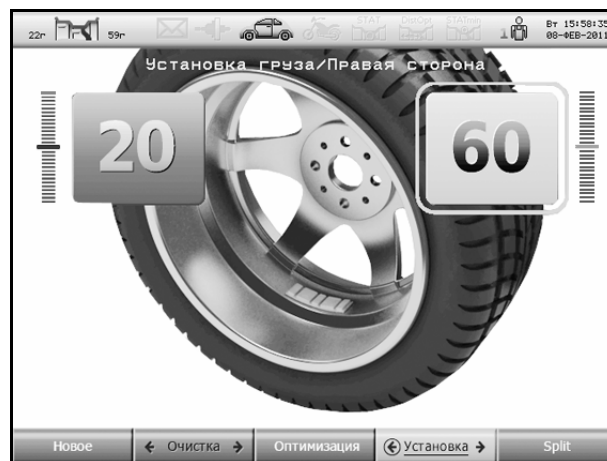
б – установка в «6 часов» справа
