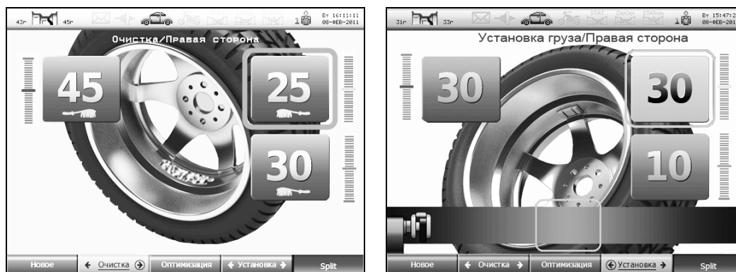
Рисунок 7.3 – Экраны очистки и установки грузов в режиме Split
