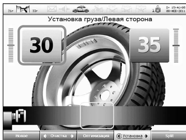
Рисунок 5.12 – Экран при установке груза линейкой
