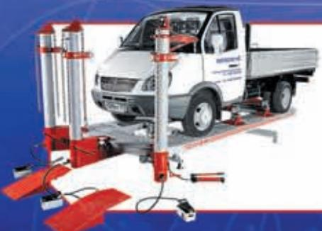
Просторная широкая платформа 5,2 x 2,1 м. позволяет закреплять широкую гамму автомобилей от малолитражек, до внедорожников и легких грузовиков весом до 3500 кг. Для крепления кузовов автомобилей, не имеющих отбортовки порогов (MB, BMW и др.) и рамных автомобилей, используются специальные адаптеры (поставляются дополнительно).
