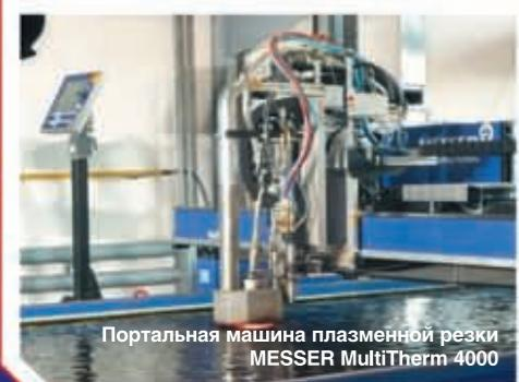
Портальная машина плазменной резки
