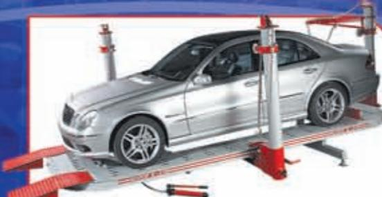
Стапель позволяет в считанные минуты установить и снять любой автомобиль, даже с заблокированными колесами (необходима дополнительная лебедка и тележки под колеса). Гидравлический подъемник наклоняет платформу, автомобиль закатывается по въездным трапам, после чего фиксируется на платформе.
