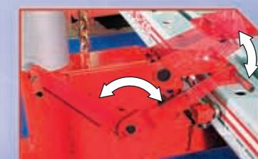
Силовые устройства расположены непосредственно на платформе. Оснащенные роликами, они легко передвигаются вокруг платформы, создавая рабочую зону в 360°.
